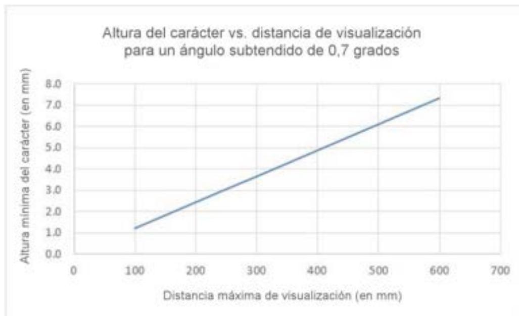
Figura 1 – Relación entre la altura mínima de los caracteres y la distancia de visualización máxima según diseño
